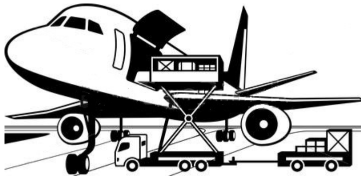
Chargeur K - Cargaison nécessitant un chargement à haute levée le long d'un aéronef
